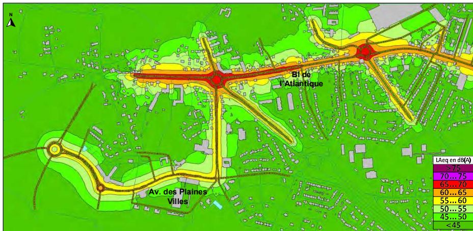
Figure 67 : Niveaux sonores à 4 m de hauteur – Situation initiale – Période diurne (6h – 22h) – Secteur Ouest 1
