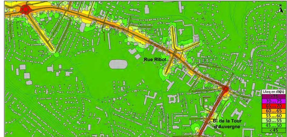
Figure 68 : Niveaux sonores à 4 m de hauteur – Situation initiale – Période diurne (6h – 22h) – Secteur Ouest 2
